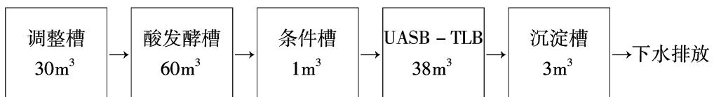
在调整槽将一次贮留的排水送至酸发酵槽，在两发酵槽内，填充表面积大的载体，利用载体上保持的共性嫌气性菌进行有机酸发酵。可使基质低分子化及去除氧，抑制  $\text{CO}_2$  发生，提高沼气转换效率。在条件槽进行 pH 和温度调整后，被送往 UASB - TLP 的排水，通过沼气发酵，有机物被转换为沼气。由于 UASB - TLP 是多段结构，短距离流被抑制，达到高的去除率。在沉淀槽少量流出的小颗粒污泥被回收，处理水可直接由下水道排放。
