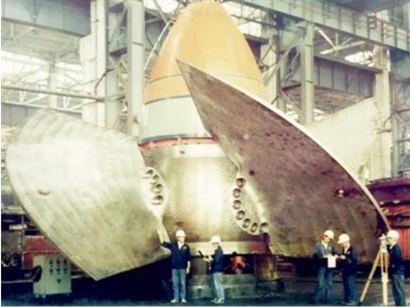
东方电机研制的葛洲坝 17 万千瓦轴流转桨式转轮。
