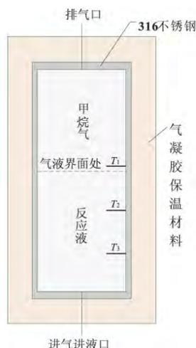
图 2 反应釜结构详图
